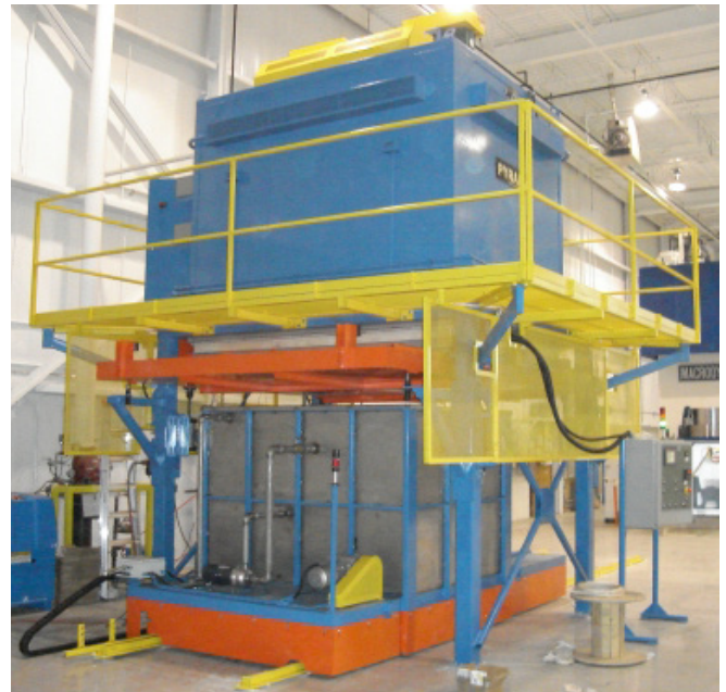
Projet de four de trempe électrique
